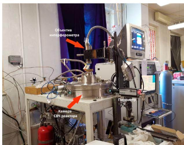
Рис. 1. Фотография СВЧ-плазмохимического реактора ARDIS-100 для синтеза алмаза.
