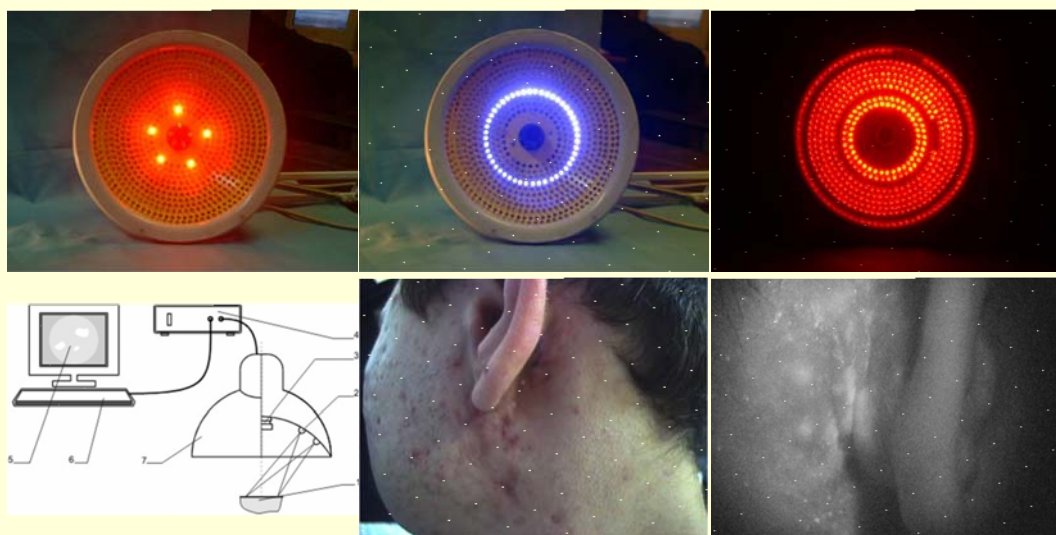
Видеофлуоресцентная светодиодная матрица в режиме диагностики и терапии. Видимое и флуоресцентное изображение, полученное с помощью устройства.
