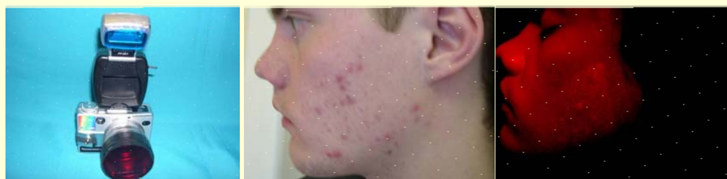
Автономный видеофлуоресцентный анализатор изображений. Видимое и флуоресцентное изображение, полученное с помощью устройства.
