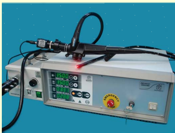
Макет лазерного флуоресцентного гастроскопа на базе гастроскопа производства OLYMPUS
